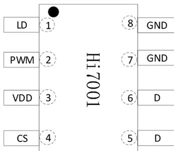
\* (5、6 PIN 为散热引脚，必须进行散热处理)
