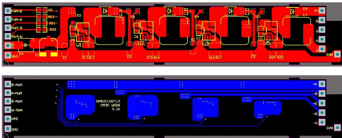
图 11.2 四路 RGBW 共阳连接电路布局布线图
